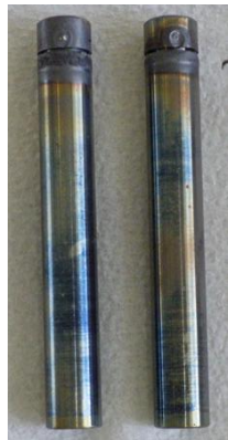
① 800℃-10分加熱後の封入ピン外観と切断面画像
